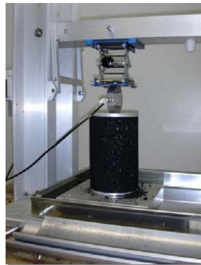
Fig. 2 Cohesion test apparatus.
